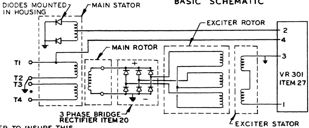
\* USER TO INSURE THIS GROUND CONNECTION IS MADE. SINGLE PHASE (ALL)
